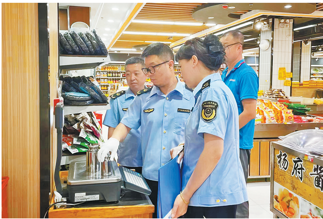
● 工作人员用标准砝码检测电子秤的准确性
